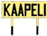
Kaapeli- ja johtotaulu (kuvassa kaapelitaulu)
